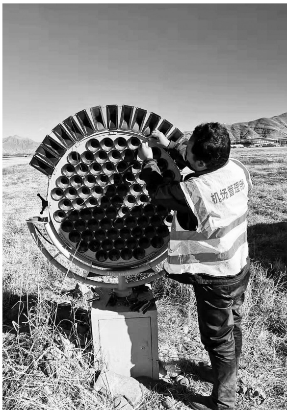
工作人员正在维护定向声波驱鸟设备。图由民航西藏区局提供
