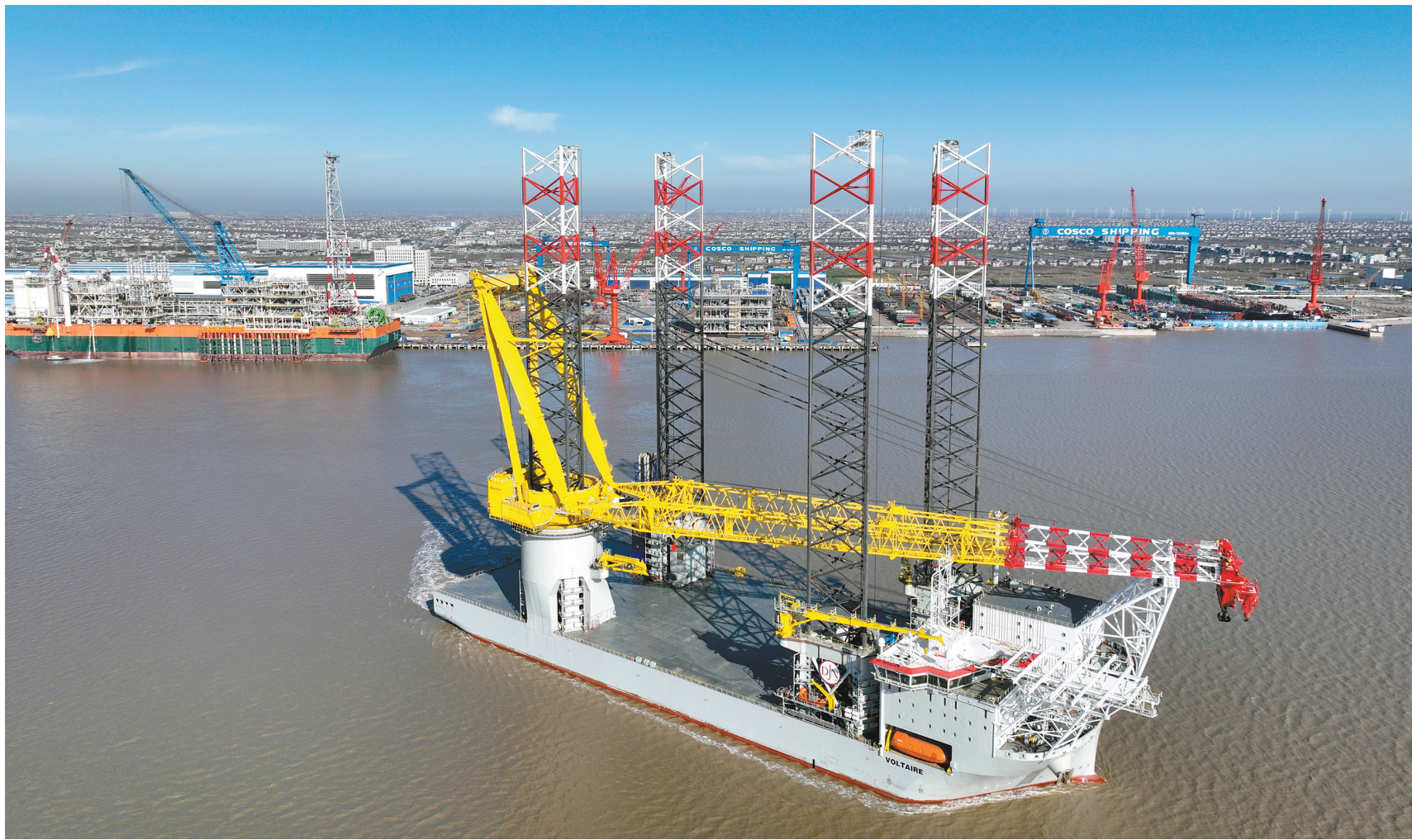
12月20日，由江苏启东中远海运海工为国外客户订制的N966自升式风电安装船交付启航。据介绍，该船主吊机起重能力超过3200吨，最大吊高达325米，最大作业水深超过80米，有效载荷超过16000吨，达到欧五排放标准。
