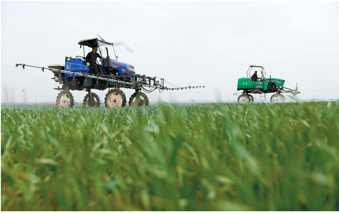
图为4月5日,山东省青岛市即墨区段泊岚镇刘家营里村的农民使用自走式高杆喷雾机在麦田里喷洒叶面肥。
