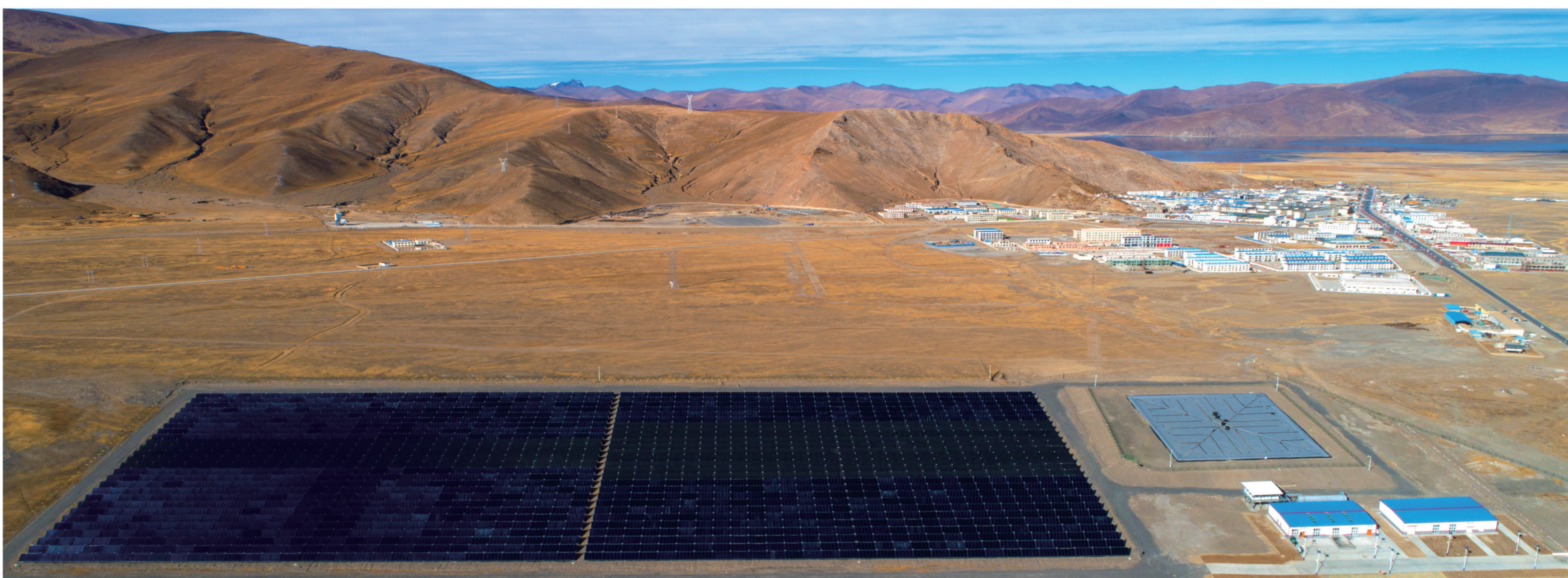
山南浪卡子县城（2018年）西藏第一个大型太阳能供暖项目 采暖建筑面积一期约9万平方米
